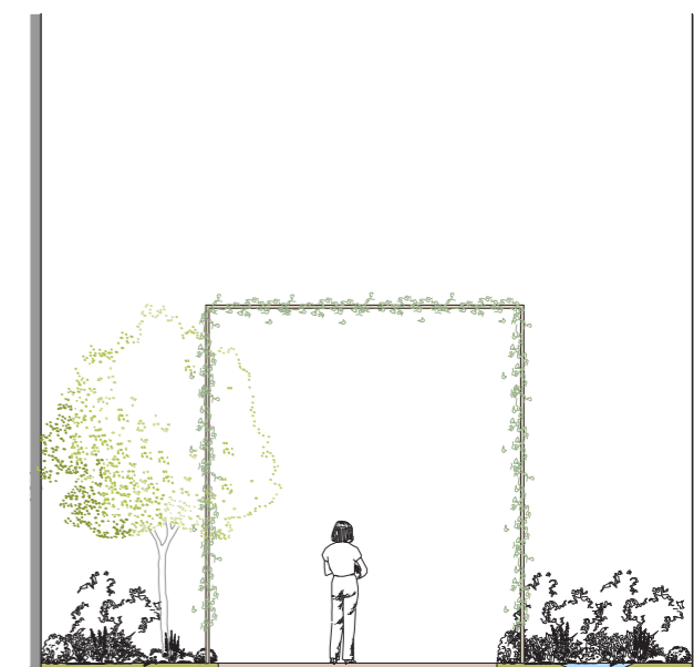
Grønn portal med flersjiktet vegetasjonsfelt og håndtering av overvann.
