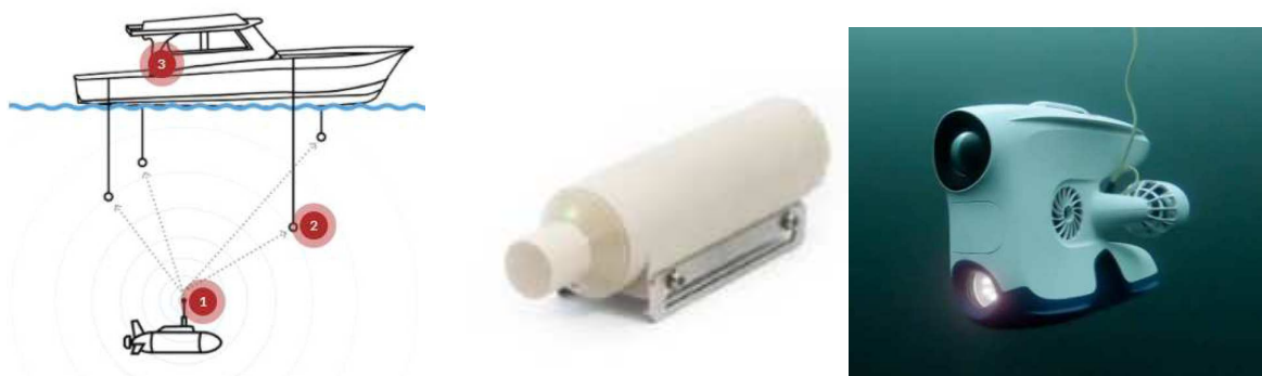
Figur 3-1 Undervannsposisjonering Waterlinked og drone (Blueye) benyttet.
