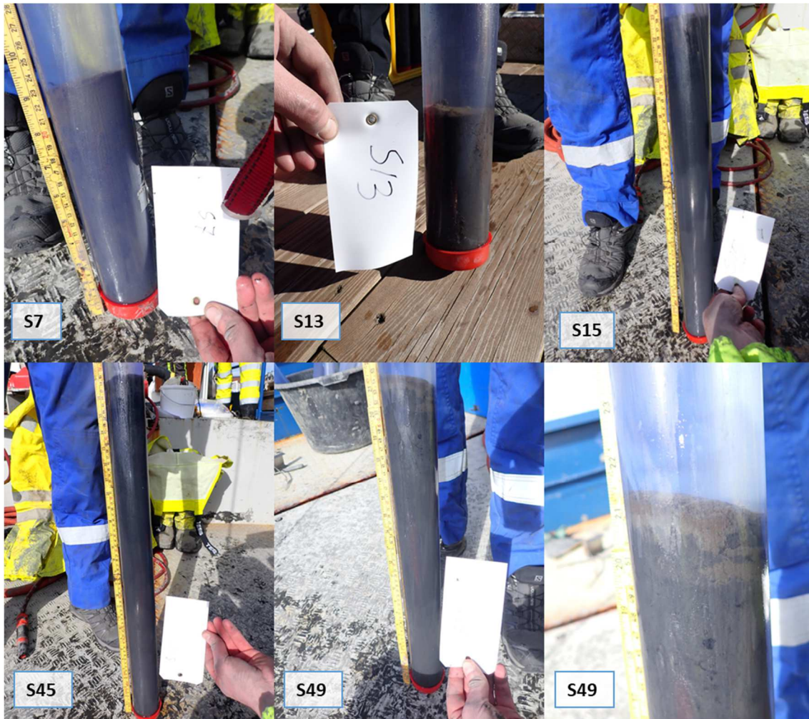
Figur 4-1 Bilder av hver kjerneprøve fra felt, inkludert et bærbilde av brun fluff på toppen av kjerneprøven på S49.
