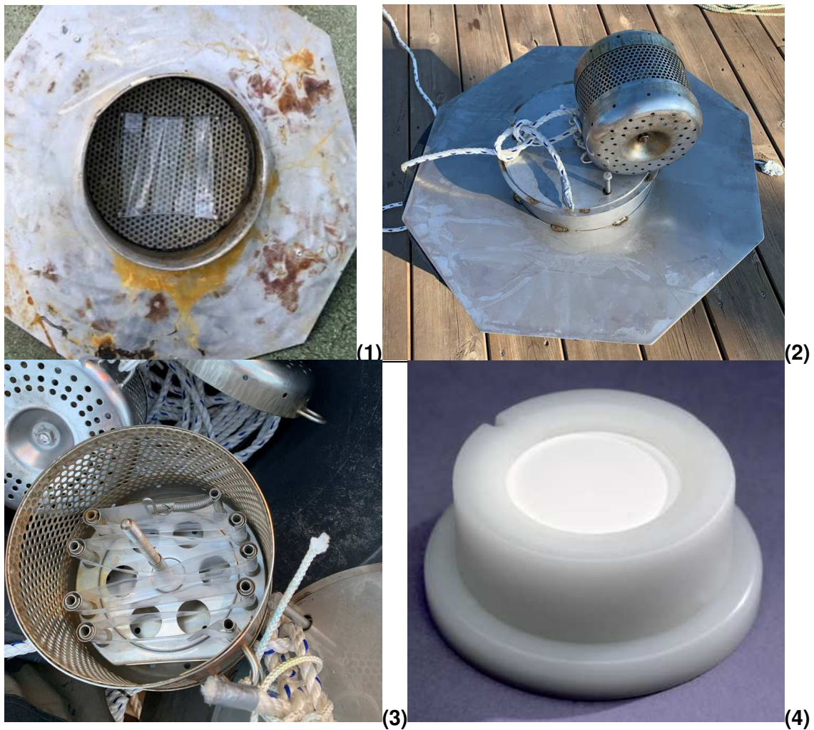
Figur 3-13 Passive prøvetakere. (1) Fluks kammer med SPMD membran direkte over havbunnen (NGI), (2) Fluks kammer med bur for SPMD, (3) SPMD membran i bur, (4) DGT for analyse av metaller.
