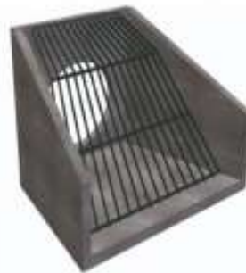
Fig. 10. Bekkeinntak med rist. Ukjent kilde.
