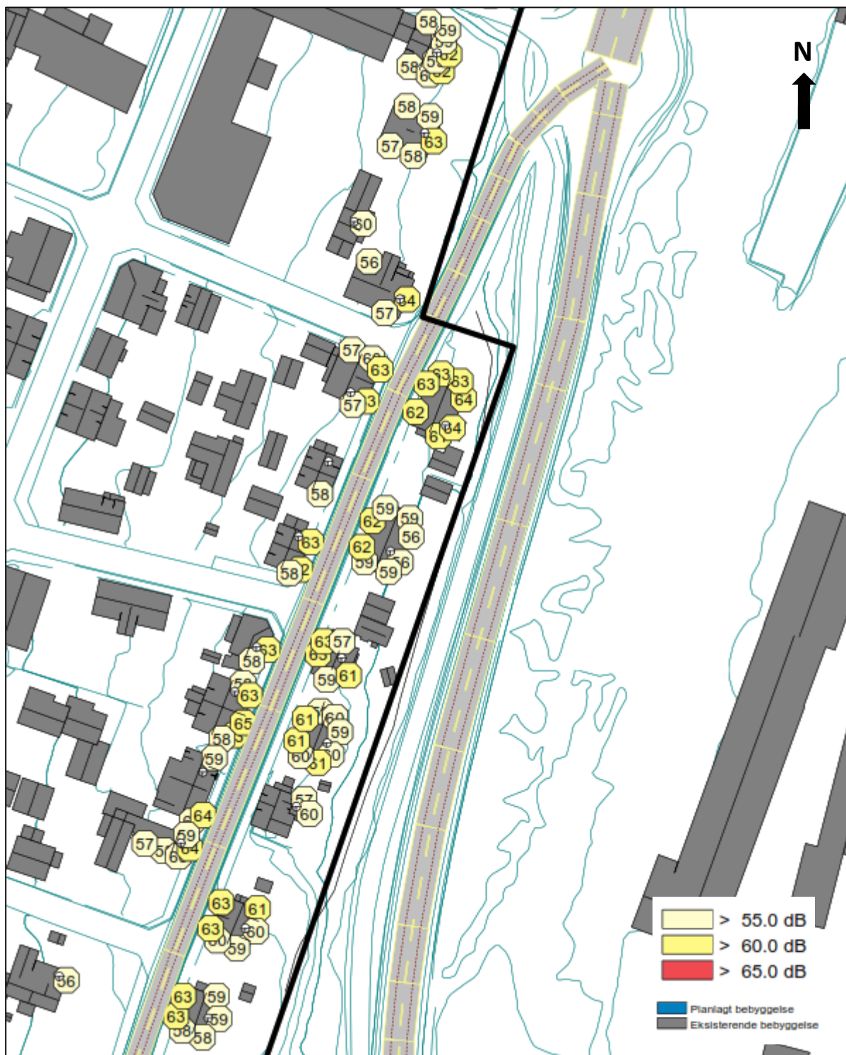
Figur 4-1: Høyeste fasadenivåer i dagens situasjon ved eksisterende bebyggelse. Vegtrafikkstøy.
