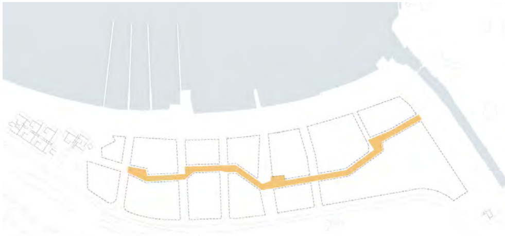
Figur 5.18: Traséen til Heivei er tilpasset eiendomsgrenser og utbyggingsmuligheter, noe som gir et variert og spennende gateløp.
