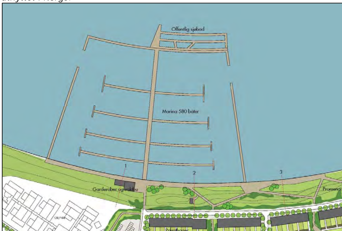
Figur 5.35: Illustrasjon av stor småbåthavn med bølgebryter, parallelloppdrag fra Futhark/Asplan Oslo. Dette anlegget er dimensjonert for 600 båter.
