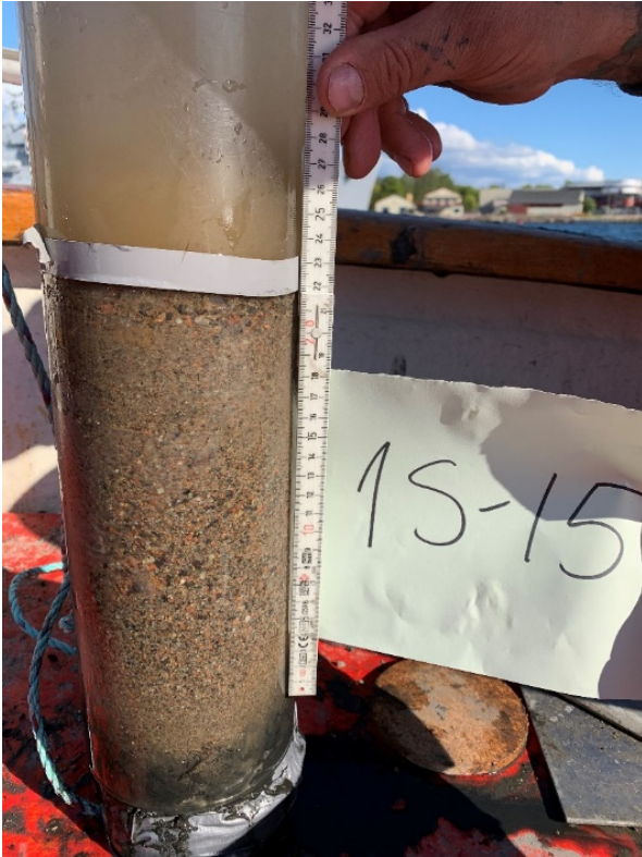
Figur 12: Eksempel på kjerneprøve fra kontroll av lagtykkelse ved Indre havn Horten. I bunnen vises overgangen fra nye tildekkingsmaser til gammel sjøbunn.
