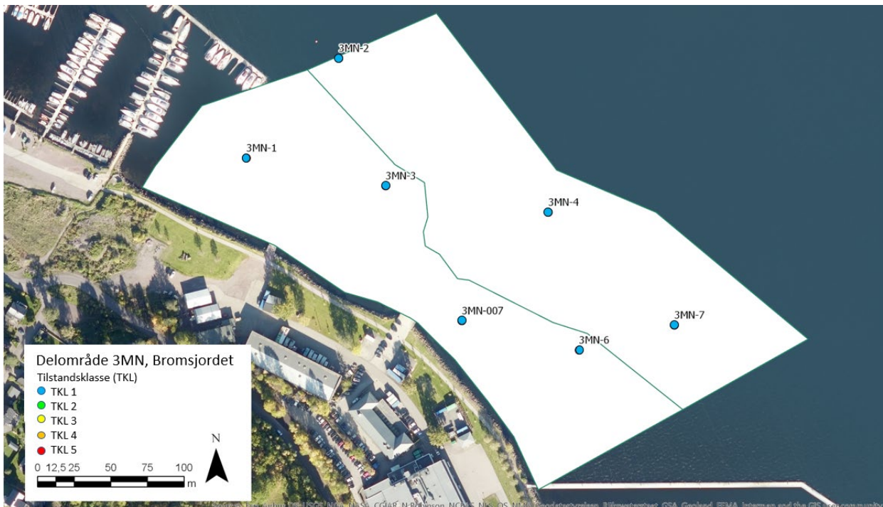
Figur 20: Oversikt over høyeste registrerte tilstandsklasse for metaller, PAH og PCB ved Bromsjordet, utenfor Kongsberg Maritime i forbindelse med prosjektet Ren Indre havn Horten, 2019-2020. Konsentrasjoner under rapporteringsgrensen er ikke tatt med.
