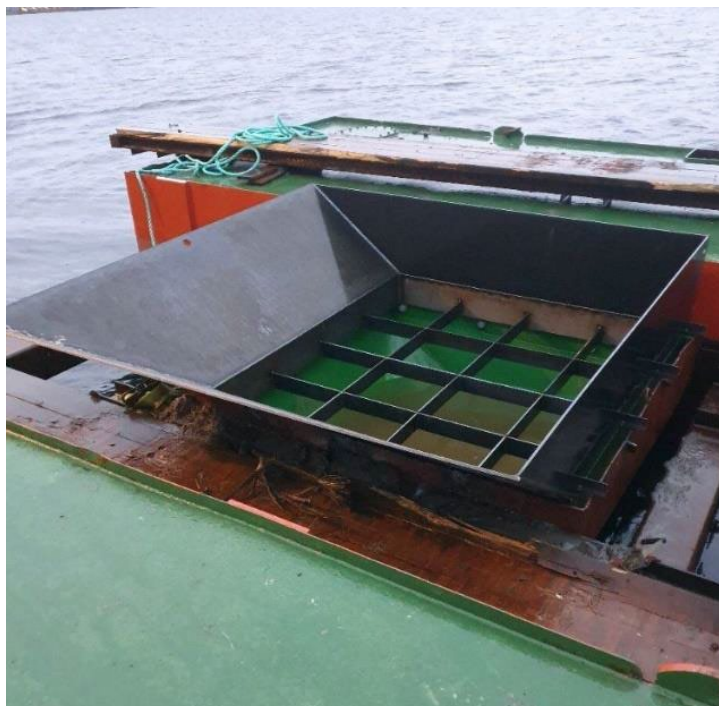
Figur 4: Installasjon for deponering av mudringsmasser.
