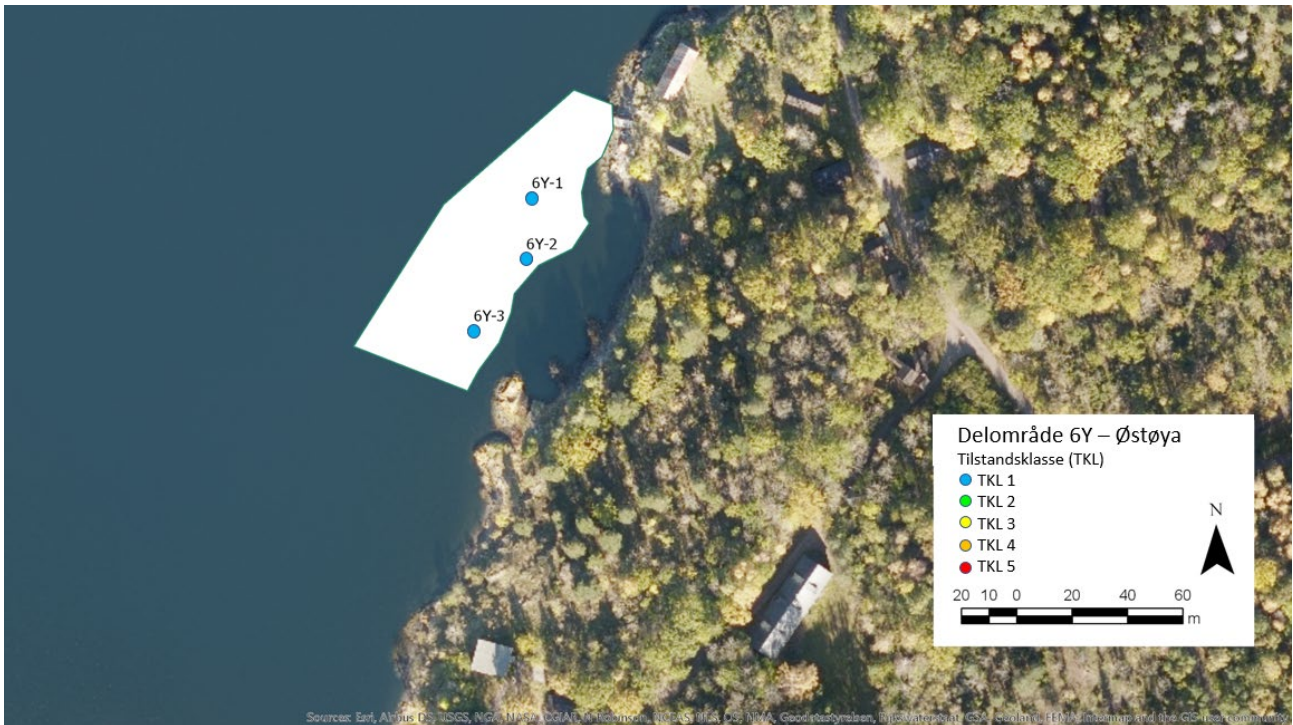
Figur 18: Oversikt over høyeste registrerte tilstandsklasse for metaller, PAH og PCB i filterlaget ved Østøya i forbindelse med prosjektet Ren Indre havn Horten, 2019-2020. Konsentrasjoner under rapporteringsgrensen er ikke tatt med.
