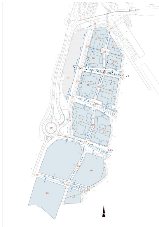
Figur 26: Skisse åpen overvannshåndtering HS1.
