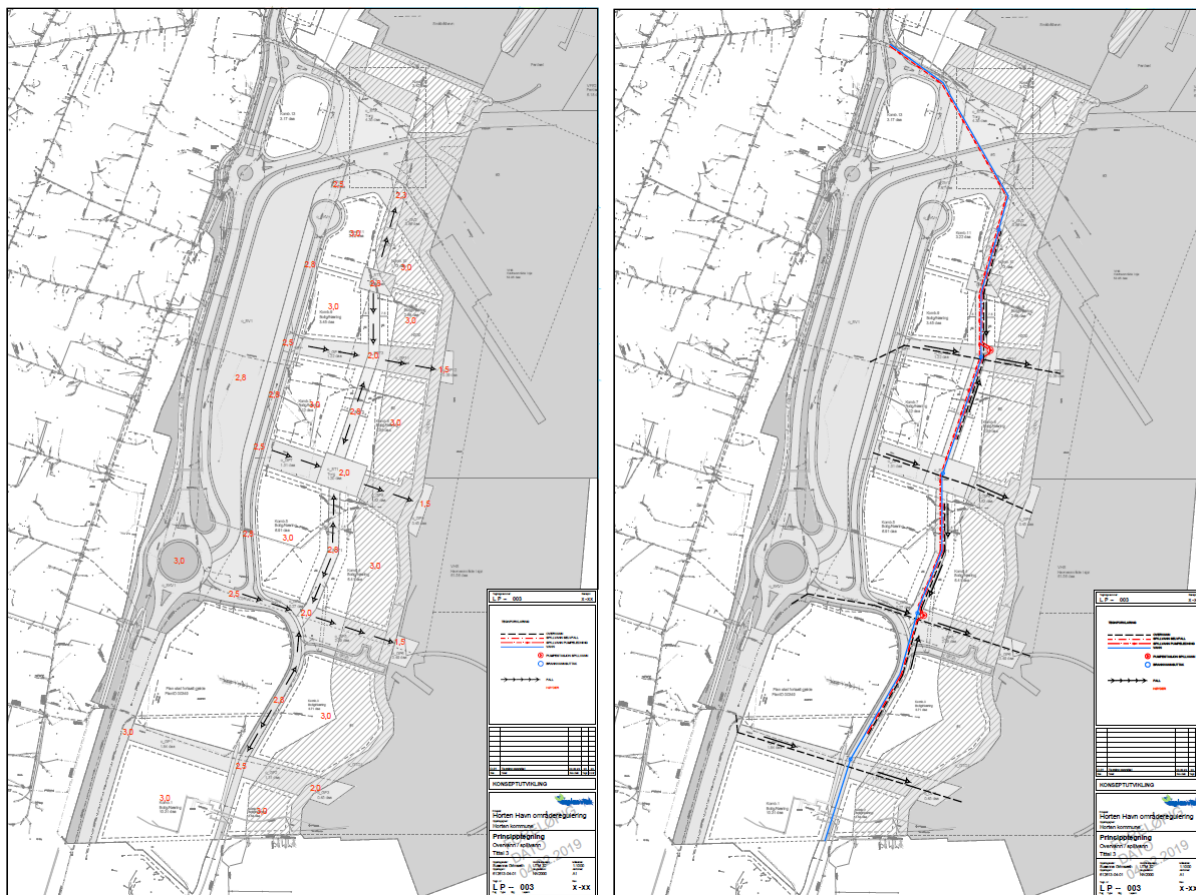
Figur 42: hovedprinsipp for overvann og VA-løsning gjennom området
