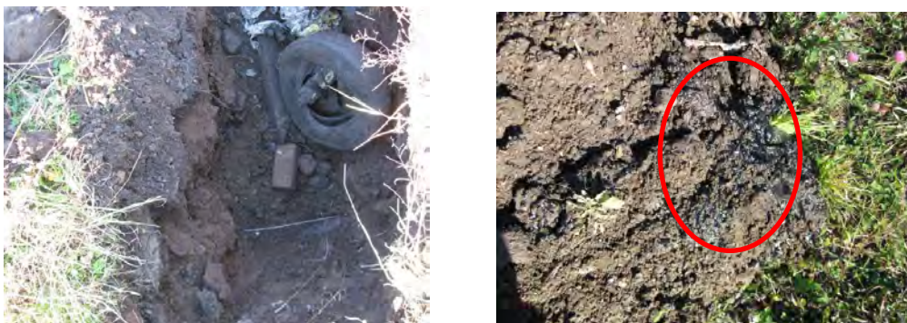
Figur 5: Grunnen i delområde G1 er full av søppel (venstre), og det ble også påvist tykflytende olje i to av prøvepunktene (høyre, markert med rødt).
