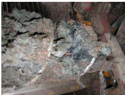
Figur 9: Borprøve tatt opp fra et av punktene midt på Bromsjordet, tilsvarende farlig avfall (på området til Horten kommune, teknisk etat).
