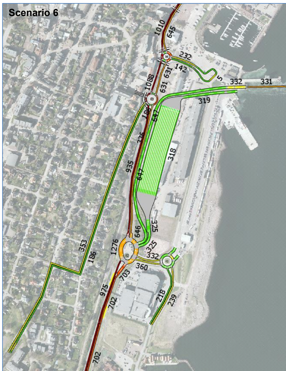
Figur 31: Gjennomsnittlig simulert trafikkmengde (kjøretøy/time) i simuleringsperioden mellom 15:00 og 17:00 i Scenario 6. Simulert trafikk er noe lavere enn trafikketterspørselen tilsier da flere kjøretøy blir stående å vente i Strandpromenaden, på utsiden av modellområdet.
