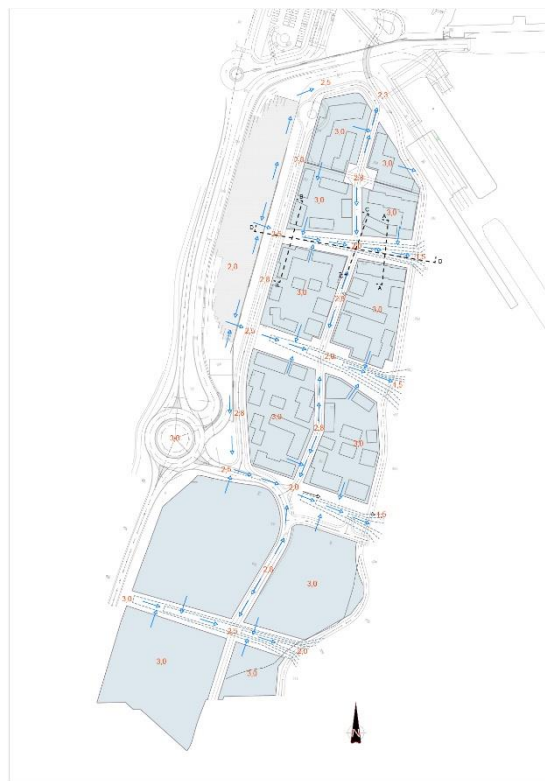
Figur 26: Skisse åpen overvannshåndtering HS1.
