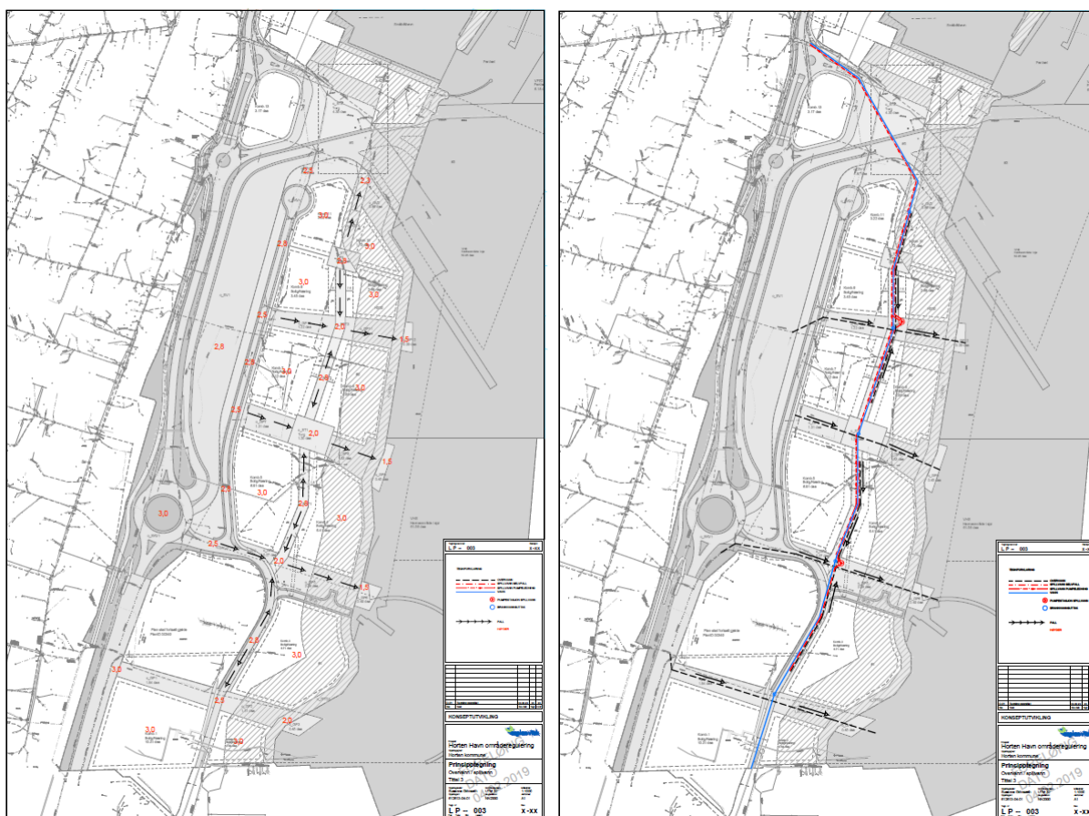
Figur 42: hovedprinsipp for overvann og VA-løsning gjennom området
