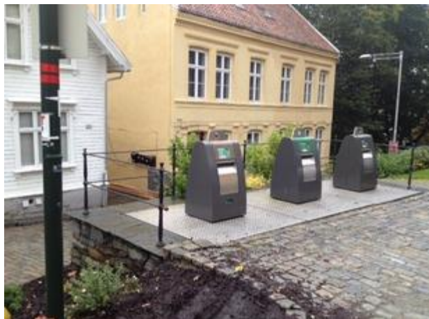
Bilde 5 og 6: Eksempel på nedgravd avfallskontainer.
