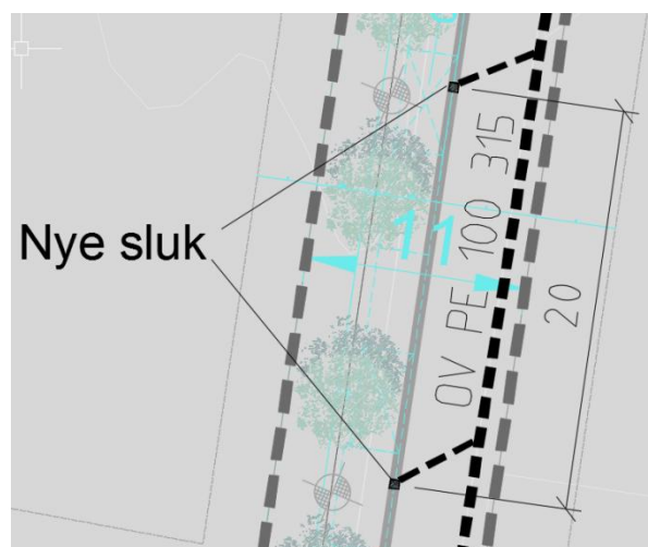
Figur 58 Eksempel på slukplassering med tilkobling ny overvannstrase.
