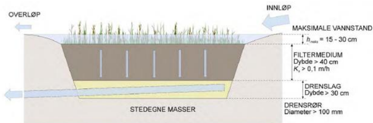
Figur. 2. Oppsummering av de viktigste kriterier ved anleggning av regnbed (fra Paus og Braskerud, 2013). H_{max} er mulig vannstand, K_s er infiltrasjonshastigheten.
