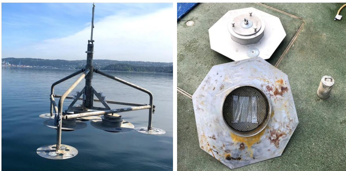
Figur 25 Foto til venstre viser en tripod som er på vei til å settes ut, de tre flukskamrene er i senter av ramma. Foto til høyre viser et flukskammer som står slik det står på sjøbunnen (bak), og et flukskammer som viser hvordan SPMD-membranen er montert.
