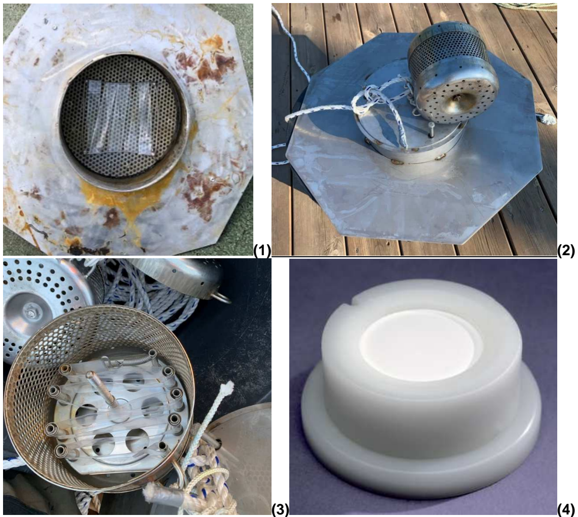
Figur 3-10 Passive prøvetakere. (1) Fluks kammer med SPMD membran direkte over havbunnen (NGI), (2) Fluks kammer med bur for SPMD, (3) SPMD membran i bur, (4) DGT for analyse av metaller.
